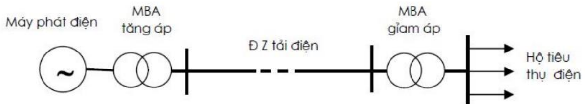
Hình 1.1: Sơ đồ mạng truyền tải điện đơn giản
